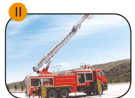
İtfaie merdiveninin uzaması
